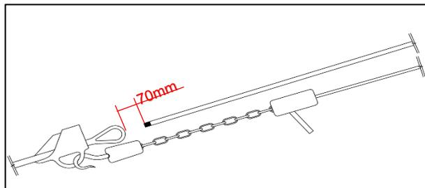
**2)** Aplique fita plástica isolante no cabo a uma distância de aproximadamente 70mm entre o cabo e o olhal. Corte o excesso do cabo.
