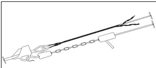
**5)** Faça a aplicação da segunda perna da Alça Preformada, fazendo coincidir as marcas coloridas. Aplique até faltar duas voltas para completar.
