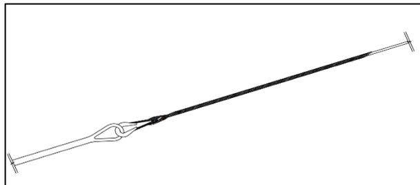
**6)** Retire os equipamentos utilizados para tracionar o cabo. Separe as varetas das pontas e forme subconjuntos com uma ou duas varetas. Finalize a aplicação da Alça Preformada aplicando os novos subconjuntos sobre o cabo.
