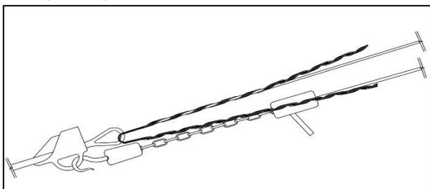
**3)** Posicione a Alça Preformada próxima ao olhal, fazendo coincidir a curva da alça com o olhal. Faça a aplicação da primeira perna no cabo, começando pela marca de cor mais próxima da curva da Alça Preformada. Aplique até faltar duas voltas para completar.
