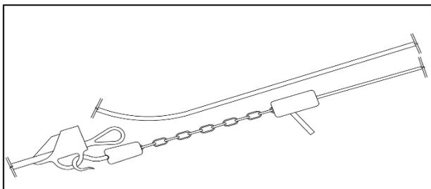
**1)** Faça o tracionamento do cabo em que será aplicada a Alça Preformada. Tracione-o com uma tensão ligeiramente superior da desejada para compensar perdas de tensão.
